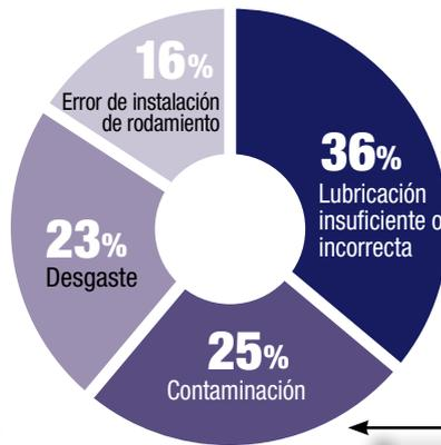
**El 61% de las fallas en los rodamientos se deben a problemas de lubricación**
